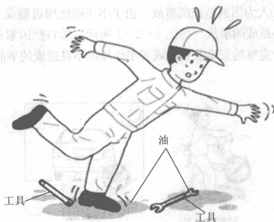
图 1-2-3 地面油污和乱放的工具可能引发的事故
