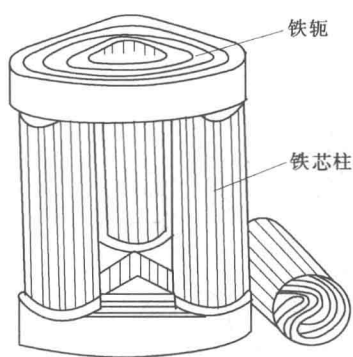
图 1.9 三相渐开线形铁芯
