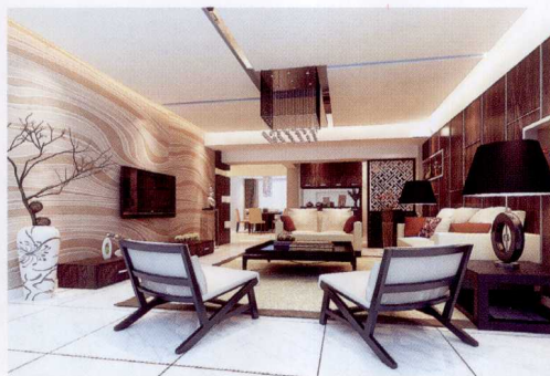
沙发墙 [ 木饰面板 + 不锈钢线条收口 ]
