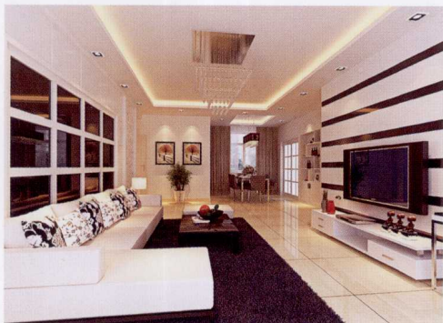
沙发墙 [ 烤漆玻璃 + 木线条打方框刷白 ]
