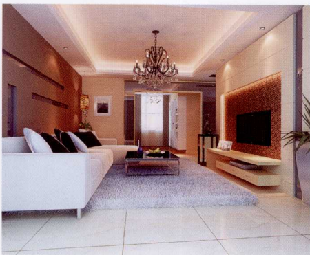
沙发墙 [ 石膏板造型 + 灰色墙面乳胶漆 + 灰镜 ]
