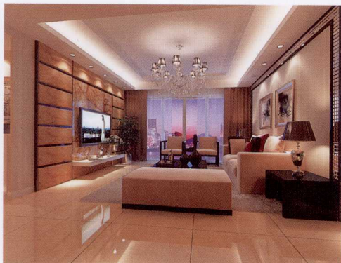
沙发墙 [ 墙纸 + 马赛克 + 木线条收口 ]
