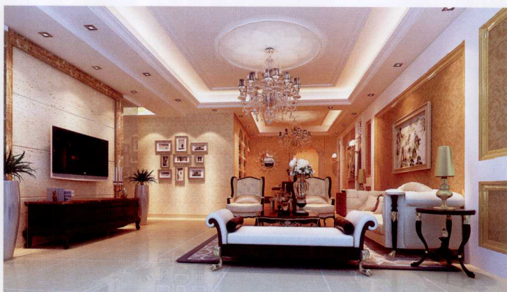
沙发墙 [ 墙纸 + 木线条刷金漆收口 ]
