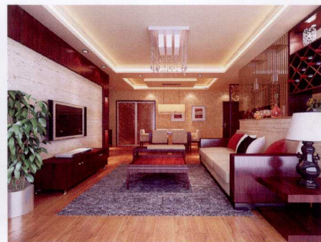
沙发墙 [ 洞石拉缝 + 装饰搁板 + 木线条密排 ]
