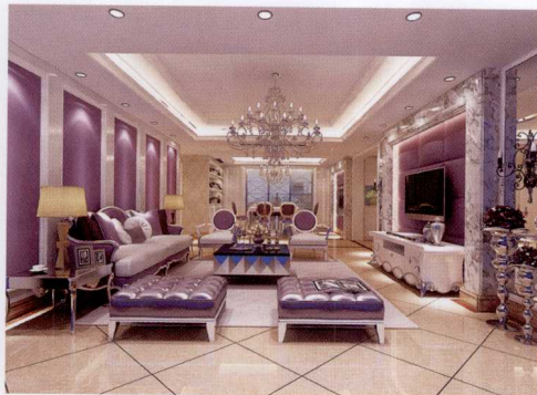
沙发墙 [ 墙纸 + 木饰面板装饰框刷白 ]
