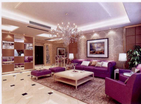
沙发墙 [墙纸 + 布艺软包 + 不锈钢线条收口]
