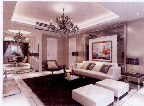
沙发墙 [ 黑镜 + 不锈钢线条收口 + 灰色墙面乳胶漆 ]
