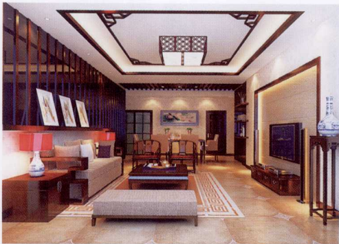
沙发墙 [ 墙纸 + 木线条间贴 + 烤漆玻璃 + 装饰搁板 ]
