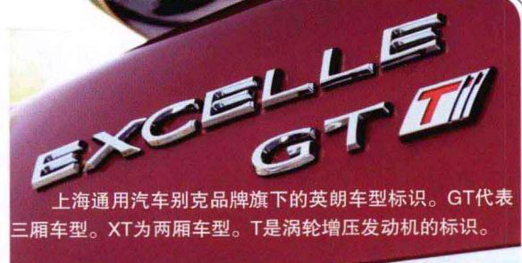
上海通用汽车别克品牌旗下的英朗车型标识。GT代表三厢车型。XT为两厢车型。T是涡轮增压发动机的标识。
