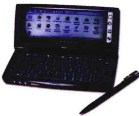
掌上电脑 (Personal Digital Assistant, PDA) 是一种运行在嵌入式操作系统和内嵌式应用软件之上的、小巧、轻便、易带、实用、价廉的手持式计算设备。它在体积、功能和硬件配备方面都比笔记本电脑更加简单轻便。按使用来分类，PDA分为工业级PDA和消费品PDA。工业级PDA主要应用在工业领域，常见的有条码扫描器、Rfid读写器和POS机等；消费品PDA包括的较多，如现在的智能手机、电子导航器和手持的游戏机等都可以称为消费品PDA。
