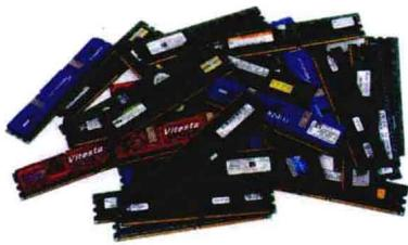
内存是CPU处理数据的中转站，内存的容量和存取速度直接影响CPU处理数据的速度。
