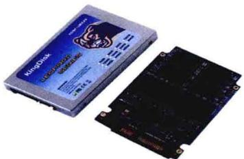
SSD固态硬盘的存储介质为闪存（Flash芯片）和DRAM，其具有低功耗、无噪声、抗震动、低热量、体积小和读写速度快的特点，被列入移动存储设备一类。
