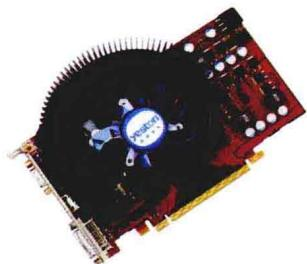
显卡又称显示适配器或图形加速卡，其功能主要是将电脑中的数字信号转换成显示器能够识别的信号（模拟信号或数字信号），并将其处理和输出，可分担CPU的图形处理工作。
