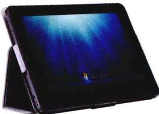
平板电脑 (Tablet Personal Computer, 简称Tablet PC、Flat PC、Tablet、Slates) 是一款无需翻盖、没有键盘、大小不等、形状各异，却功能完整的电脑。其构成组件与笔记本电脑基本相同，但打破了笔记本电脑键盘与屏幕垂直的L形设计模式，以触摸屏作为基本的输入设备，通常没有配备键盘。它拥有的触摸屏（也称为数位板技术）允许用户通过触控笔、数字笔或人手指来进行操作，而不是传统的键盘或鼠标。它除了拥有笔记本电脑的所有功能外，还支持手写输入或语音输入，移动性和便携性更胜一筹。
