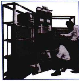
1954年，美国贝尔实验室研制成功世界上第一台晶体管电脑TRADIC，如上图所示，晶体管代替电子管成为电脑的基本电子元件，因此该时期便称为电脑的“晶体管时代”。晶体管电脑的功耗、体积和重量都大大地降低了，计算速度也提高到了每秒300万次。
