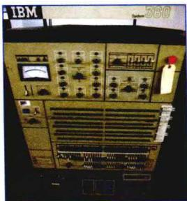
1962年，美国空军和德克萨斯公司共同研制出第一台由中小规模集成电路组成的电脑，集成电路正式代替晶体管成为电脑的基本电子元件，这个时期就是“集成电路时代”。这个时代的电脑由于采用了集成度较高、功能增强的中小规模集成电路，体积和功耗都进一步降低，价格也更便宜，运算速度提高到了每秒4 000万次。上图所示为中小规模集成电路时代最具代表性的“IBM 360电脑”。
