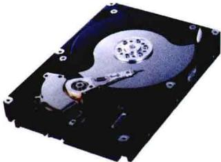
它由一个或多个铝制或者玻璃制的碟片组成，这些碟片外覆盖有铁磁性材料，用于存储数据。绝大多数碟片都被永久性地密封固定在硬盘驱动器外壳中。
