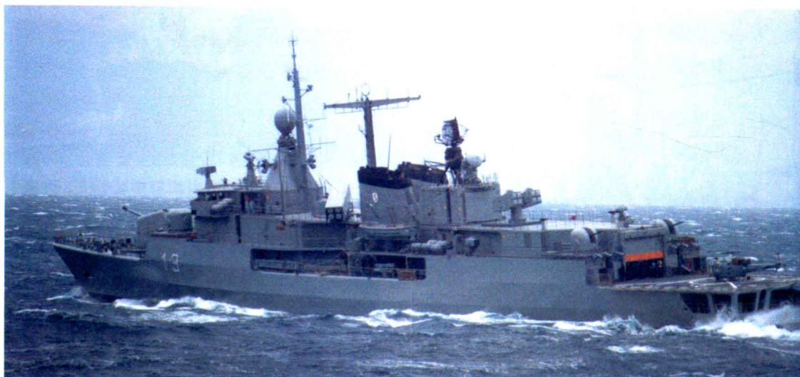
下圖：「梅科」140型戰艦（即「埃斯波拉」級）基本上是由「梅科」360型驅逐艦按照一定比例縮小出來的，屬於一種輕型護衛艦，非常適合執行反艦/反潛任務。第一批3艘「埃斯波拉」級護衛艦在建造時僅裝備一個操作直升機的飛行平臺（後來將平臺加大，能夠搭載1架AS555型「非洲狐」直升機），而後一批3艘戰艦在建造時裝備了1座伸縮式機庫，這種機庫也將加裝到先前的3艘戰艦上。這些戰艦的艦艉火砲裝置的是1門「布瑞達」火砲和2門40公厘口徑「博福斯」式火砲。此外，在艦橋前部的76公厘口徑（3英寸）「奧托·梅萊拉」火砲的後上方也將安裝1套此類火砲裝置。
