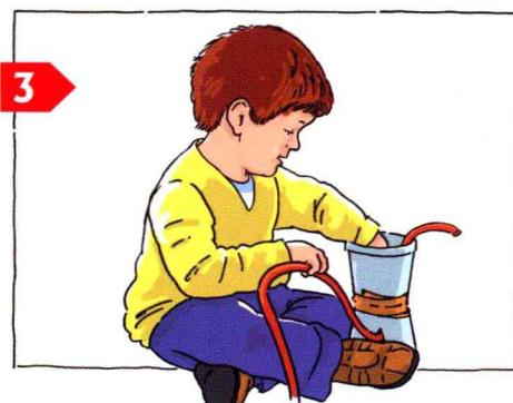
塑料管一头接在打气筒上，另一头从发射架下端的孔塞进去。
