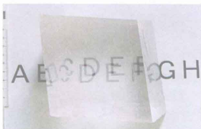
图1-4 冰洲石的双折射
