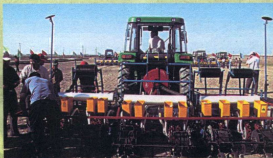
图 1-1 布管、铺膜、播种一次作业完成
