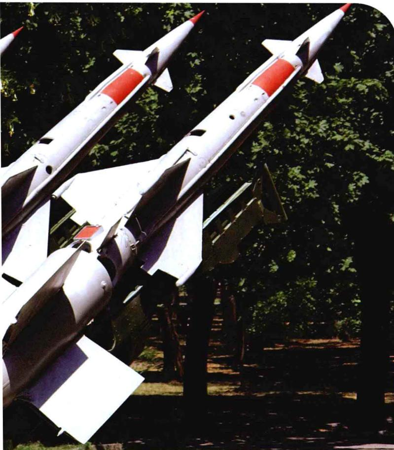
一组在乌克兰第聂伯河附近的第聂伯罗彼得罗夫斯克制造厂生产的“S”级防空导弹。它们可以击落在145千米以上高空飞行的飞机、巡航导弹和弹道导弹弹头。
