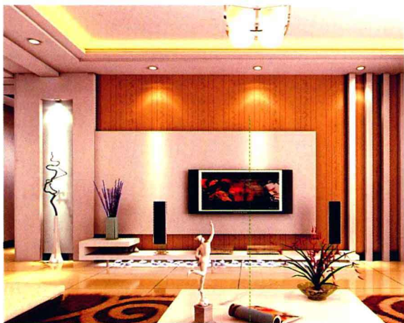
PVC壁纸+石膏板+细木工板混油
