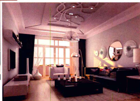
石膏板+细木工板混油造型
