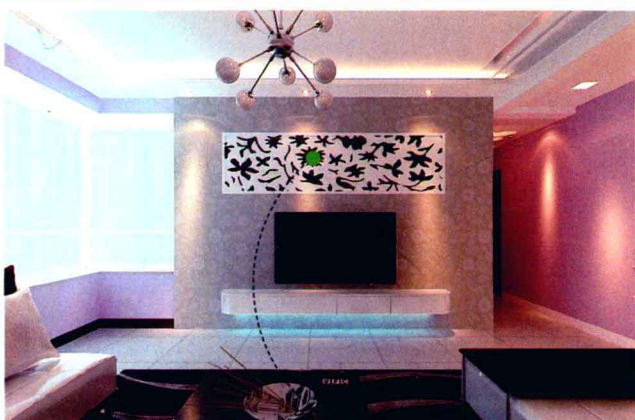
石膏板局部吊顶+PVC壁纸
