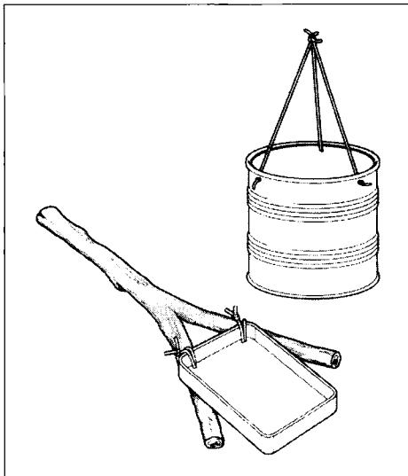
一只白铁皮罐头可以改造成为一只临时烧锅。具体操作是这样的：在铁罐的边缘处打3个孔并且分别穿上绳子。如此一来，铁罐就可悬挂于火源上方，成为烹煮食物的容器。此外另有一种式样也不妨一试：将一只较浅的白铁罐固定在叉子状的树枝上，可作平底煎锅用。选择树枝时不要使用常绿针叶树枝，因为其中含有可燃的树脂。
