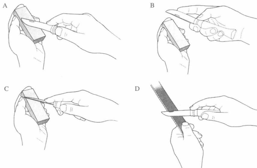
掌握正确的磨刀方法不仅事关刀具本身的使用与寿命,更是为了使用者的安全着想。钝刀使用起来更费力气,同时也更易打滑,造成意外。磨刀的最佳工具非磨刀石和磨刀皮带莫属。用水或轻质的油浸湿磨刀石。将需要打磨的刀口向下,朝着远离自己身体的方向,在磨刀石上磨 6 下;然后将刀口换个方向,并且朝着靠近自己身体的方向,再磨 6 下。磨刀过程中,刀身与磨刀石约成 30°角,保持这个角度。刀身在磨刀石上打磨锋利之后,将它在磨刀皮带上回来拉动,这可以使新打磨的刀锋更加耐用。
