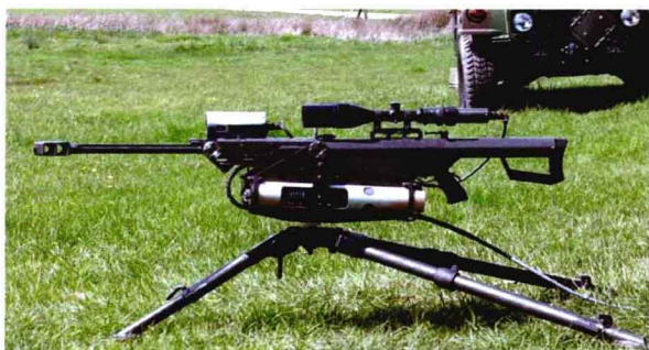
安装在 TRAP T-250 型遥控瞄准装置上试验的 M82A1
