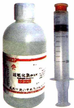
图 1-4 过氧化氢溶液和注射器改装的多功能反应仪
