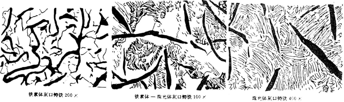
图 2-4-1 铸铁金相组织
