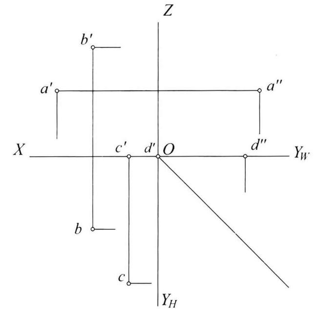
2. 根据点A、B、C的相对位置，作出三点的三面投影和轴测图。
