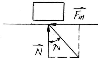
当未达到极限平衡状态时，质点所受的静摩擦力  $F$  与法向反力  $N$  间有如下关系式
