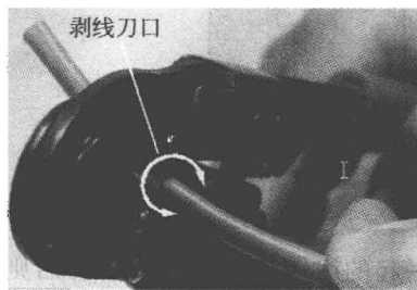
图 1-1-3 剥去网线的绝缘胶皮
