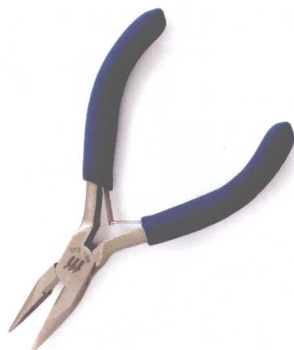
尖嘴钳： 最常用的钳子，用于安装定位珠、调整金属配件等。
