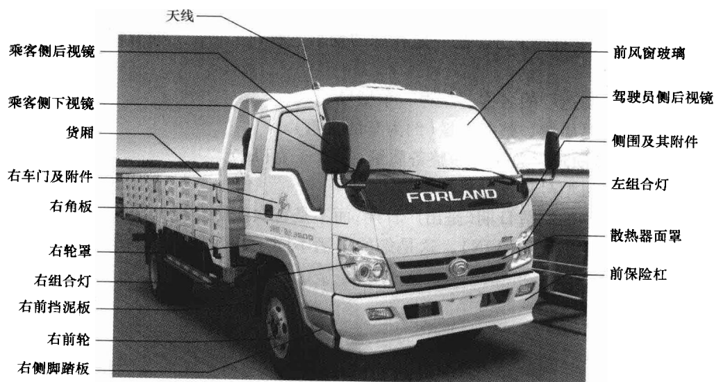
图 1-2 汽车外饰件组成示意图
