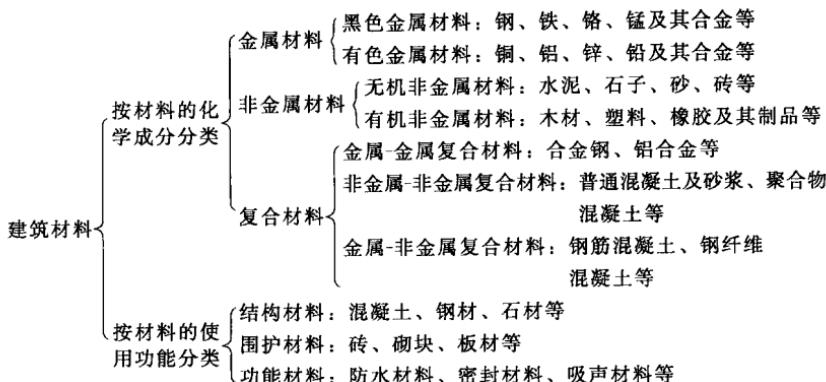
图 1-1 建筑材料的分类
