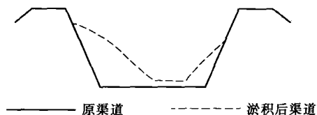
图 2-1 簸箕李引黄灌区 2005 年夏秋灌渠道干渠典型断面淤积图
