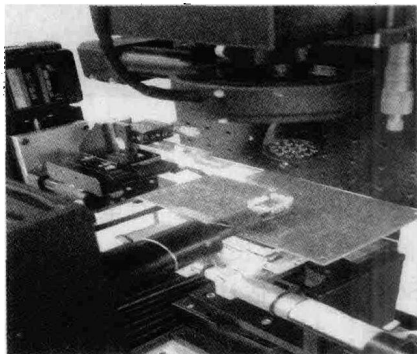
图 1-12 芯片封装中的精密对准系
