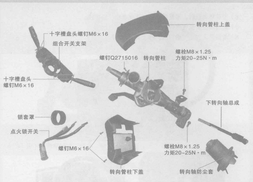
图2-14 转向管柱的拆卸
