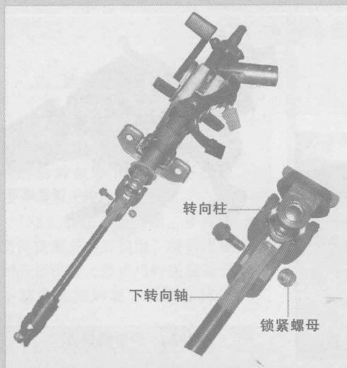
图2-18 下转向轴的拆卸
