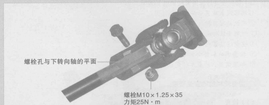
图2-20 安装下转向轴
