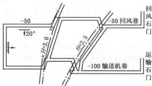
图 1-10 回采工作面施工过压开切眼处理倾向断层
