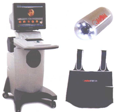
图 1-2-1 胶囊内镜系统(中国重庆金山) 右上为胶囊内镜,右下为图像记录仪背心, 左为影像工作站
