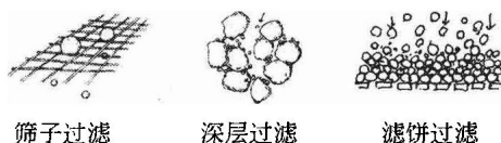
图 3 过滤一般有三种。靠孔的大小来筛选是最简单的过滤法。其次是吸附于沙粒表面的深层过滤。如果大量吸附覆盖了表面后将怎么办呢？这就成了用堵塞的沙层进行过滤了。用这些解释都不能说明为何细菌能够被去除。
