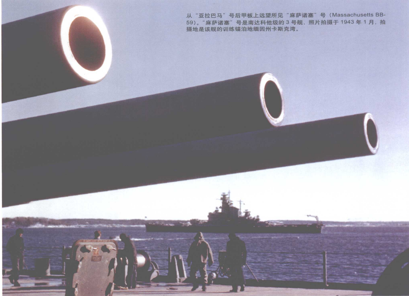
“亚拉巴马”号的前部主炮群。1942年12月或1943年1月在北大西洋海域实施射击训练时的摄影，炮塔顶盖上还残留着薄薄的积雪。其主炮的最大仰角为45度，而最大射程因炮弹种类而有所不同，使用Mk5型穿甲弹时能达到37,000米以上。炮管长为45倍口径，型号为Mk6型。
