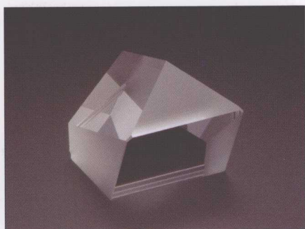
▲ D300s取景器采用特大的棱镜，它可提供明亮的取景效果，而且景物覆盖率高达100%
