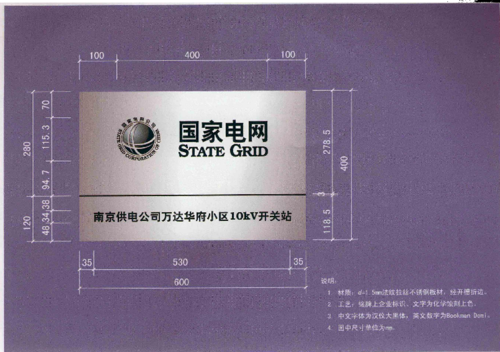
彩图1 标识板效果图 (方案1) (适用于10kV户内开关站和配电站, 悬挂在主建筑物入口处)
