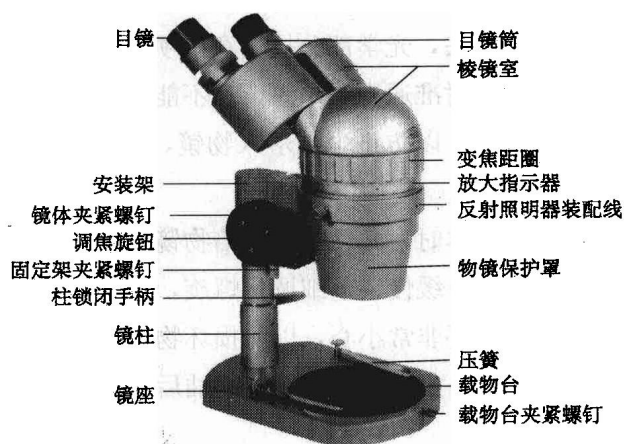
图 2 视体显微镜的基本结构
