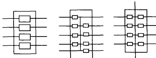
从公共端测，每个脚对地阻值与排阻上所标的阻值一样，测电阻两端值为对地阻值的两倍。
