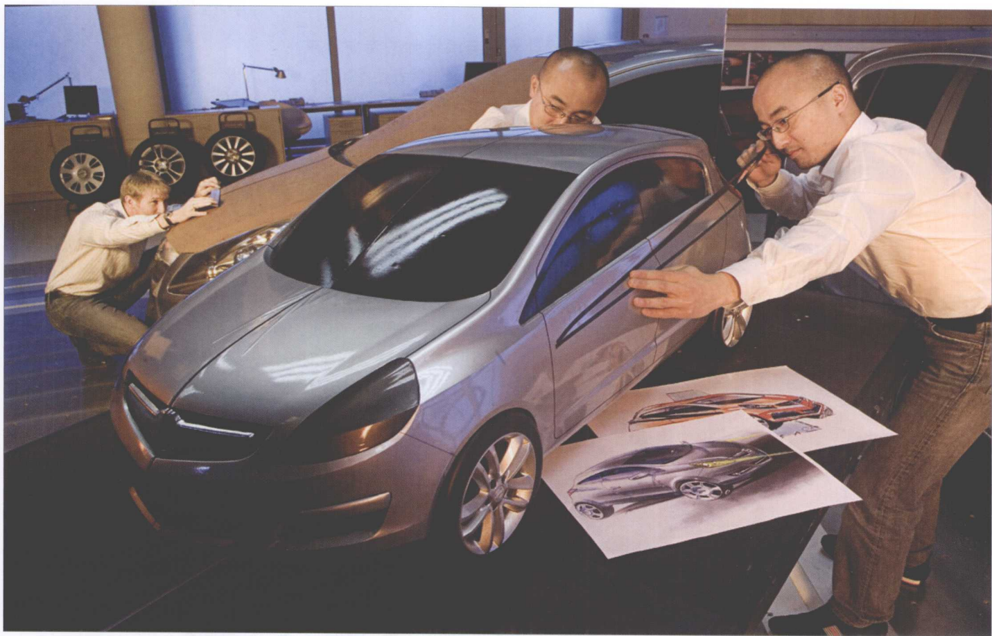
在模型制作阶段,设计师运用黑胶带检测模型曲面的光顺度。
