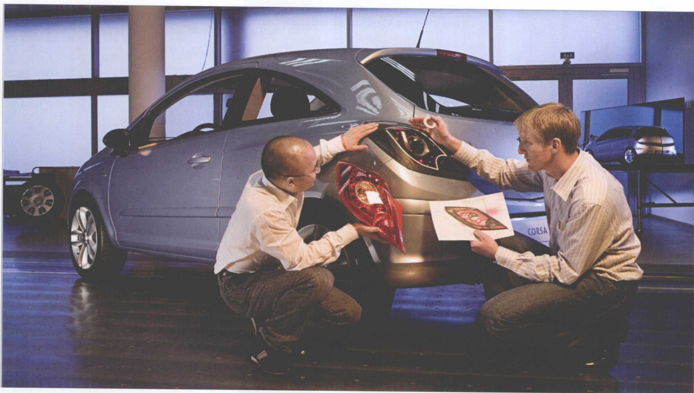
在样车完成阶段,设计师在比较设计方案与样车尾灯造型实体的差异。
