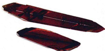
彩图6 莫斯科晶体研究所水热法合成的红色绿柱石晶体和刻面成品
