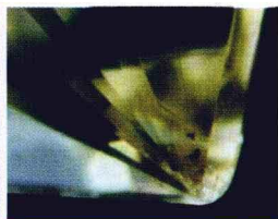
彩图21 CVD合成钻石中的针点状包裹体 和非钻石碳包裹体
