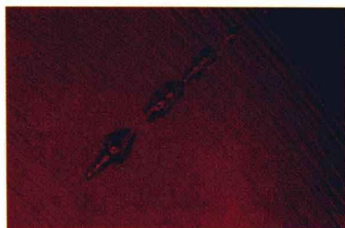
彩图2 焰熔法合成红宝石的圆形和椭圆形气泡
