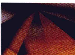
彩图17 “BARS”法黄色合成钻石的色带
