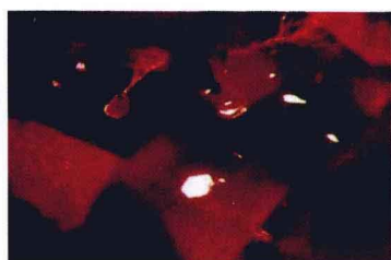
彩图11 助熔剂法合成祖母绿中的纱状和粗粒助熔剂包裹体
