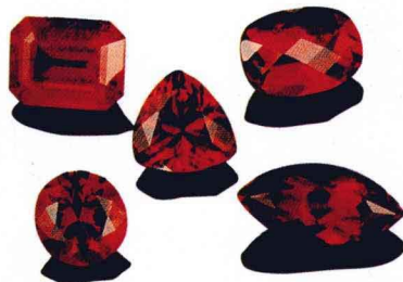
彩图6 莫斯科晶体研究所水热法合成的红色绿柱石晶体和刻面成品
