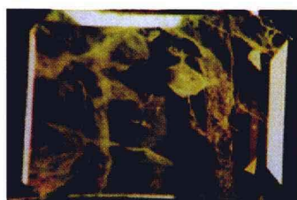
彩图11 助熔剂法合成祖母绿中的纱状和粗粒助熔剂包裹体
