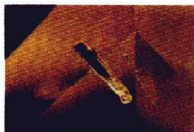
彩图16 合成钻石的金属触媒包裹体
