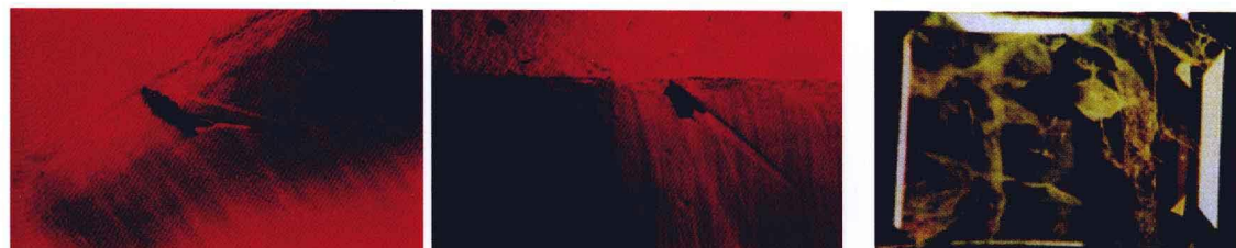
彩图10 水热法合成红色绿柱石晶体内部籽晶附近的钉头状包裹体 (左40X, 右40X)
