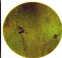
彩图5 水热法合成祖母绿中的包裹体
