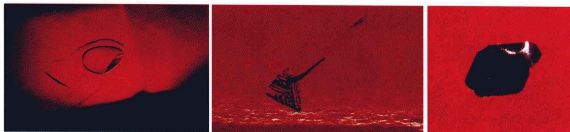
彩图9 水热法合成红色绿柱石样品内部孤立的气液或固体包裹体 (左25X, 中20X, 右15X)
