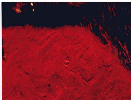
彩图7 水热法合成红色绿柱石内部的V字形交叉的生长纹（左3X，右9X）
