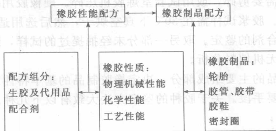
图 1-1 橡胶配方设计体系
