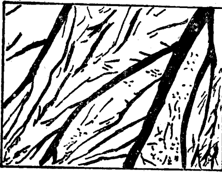
图 1-8 解理断裂口的“河流”状花样
