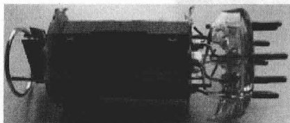
(c) 第三步: 破壳后近距离拍摄的电子管实物
