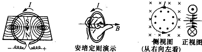
图 3-1-8 环形电流的磁场
