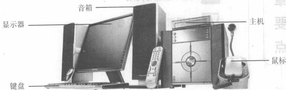
图 1-1 电脑的硬件结构图
