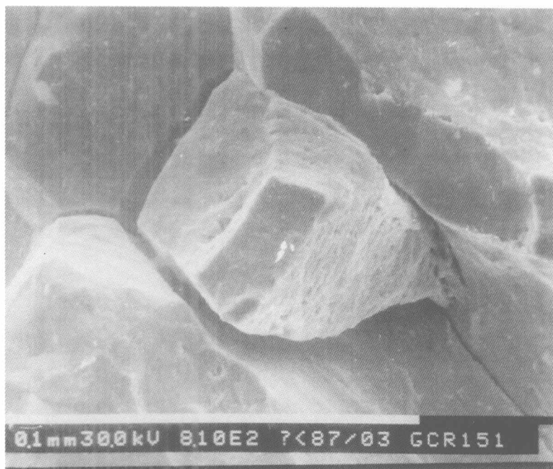
GCr15 钢过热沿晶脆性断裂断口
