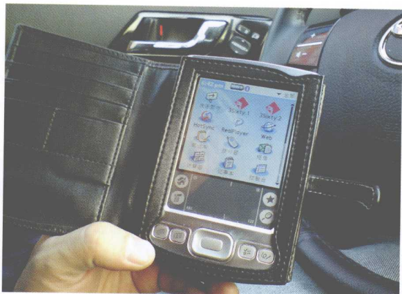
图 1-11 PDA 类型频谱分析仪
