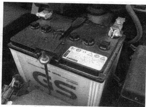
图 2.6 蓄电池的固定方式
