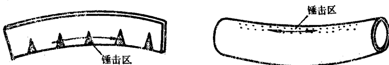
图 1.7 型材、管材的锤击矫正
