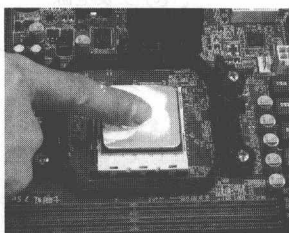
(f) 在 CPU 散热面上涂硅胶
