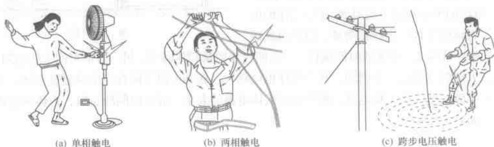
图 1.1 3 种触电的形式
