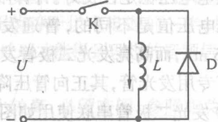
图 1.17 继电器的线圈控制电路
