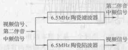
图 1—10 视频信号与伴音信号分离框图
