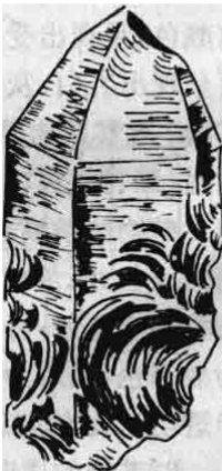
图 1—3 单晶石英的 贝壳状断口
