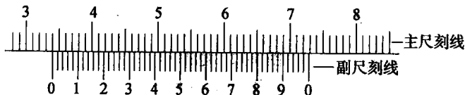
图 1-14 游标卡尺的读数方法
