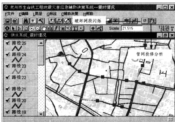
图7 供水管网抢修路径分析
